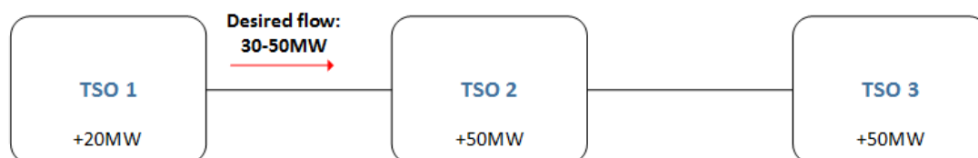
Figura 1: Exemlu de capacitate de reglaj a interconexiunii
