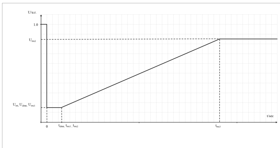
Fig. 6C. Diagrama de capabilitate privind trecerea peste defect a unui modul generator de categorie C
