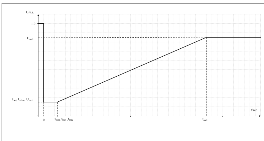
Fig. 3B. Diagrama de capacitate privind trecerea peste defect a unui modul generator de categorie B
